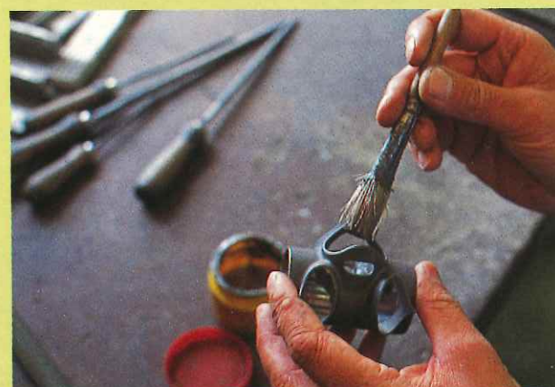
Softride-Rahmen auf Maß gebaut? Kein Problem für Pallesen. Damit das Lot die Edelstahlrohre zuverlässig benetzt, behandelt Pallesen Muffen und Rohre vorher mit einem speziellen Flußmittel, das bereits Lot enthält
