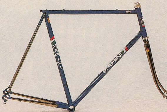
gemischt mit Sauerstoff, auf den Rahmen gesprüht. Richtig naß wird er dabei nicht – dennoch kommt er anschließend bei 130°C für eine halbe Stunde zum Trocknen in den Ofen.
