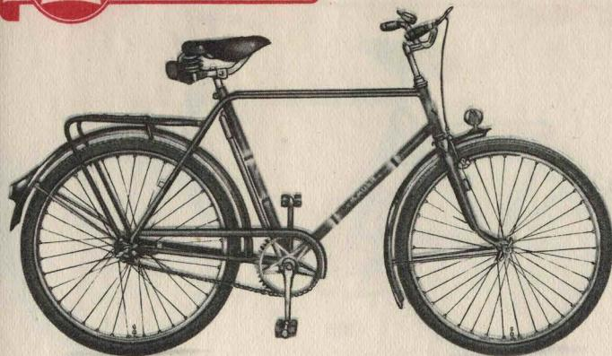
**Französisches Modell** Ein neuer Weg: Das Sportrad nach französischer Art mit 2 parallel laufenden Oberrohren beim Herrenrad bzw. 2 zum Unterrohr parallel laufenden, tiefer durchgebogenen Rohren (zur besseren Aufsteigemöglichkeit) beim Damenmodell.
