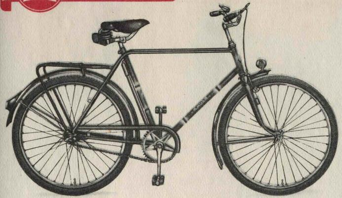
**Französisches Modell** Ein neuer Weg: Das Sportrad nach französischer Art mit 2 parallel laufenden Oberrohren beim Herrenrad bzw. 2 zum Unterrohr parallel laufenden, tiefer durchgebogenen Rohren (zur besseren Aufsteigemöglichkeit) beim Damenmodell. Ausstattung: Wie beim Modell »Bauer-Sport«, Bereifung  $26 \times 1,75$ . Farben: rot, blau oder grün. Bereifung  $28 \times 1\frac{1}{4} \times 1\frac{3}{4}$  sowie Schaltung und starre Nabe auf Wunsch.
