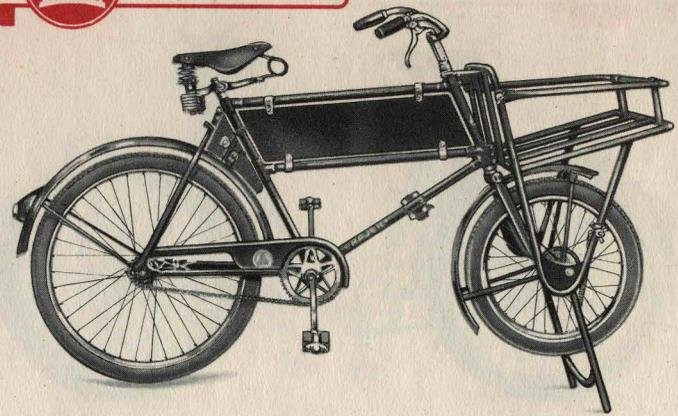
Das ideale Transportrad mit einer zusätzlichen Tragkraft von 75 kg. Zum Transport großer Gepäckstücke durch abklappbare Vorder- und Seitenteile des Gepäckraumes Vergrößerung der Tragfläche. Sonstige Ausstattung: Verstärkte Transportgabel und Speichen, V-Bremstrommelnabe, Bereifung vorn 20 x 2,25, hinten 26 x 2, Kippständer, Firmenschild. - Auch in bunt und als Damenrad.
