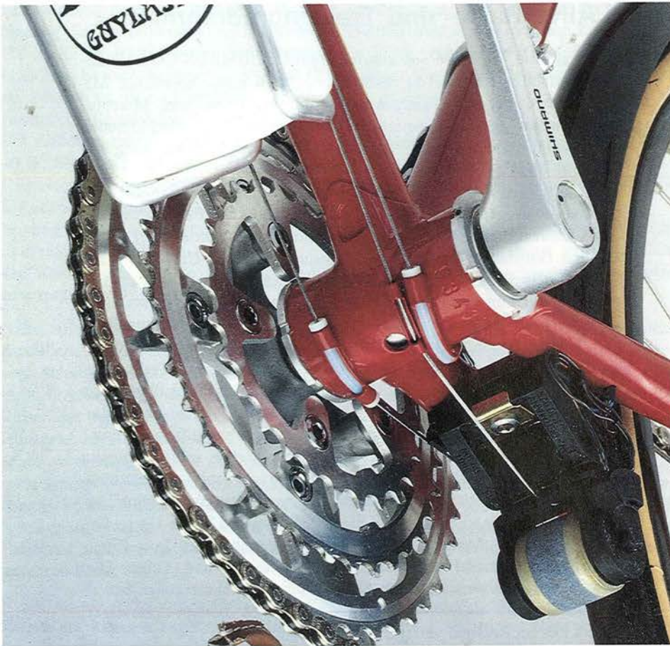
Tretlagerbereich von Modell WL mit Zugführungen und Union Walzendynamo
